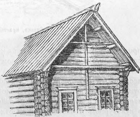
Фиг. 23. Двускатная крыша „в шпунт“. Д. Язваяя.
